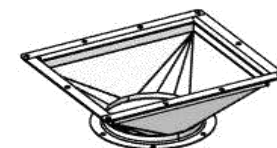
Б1-ТС-50.07.2300сд Переход D200 мм 360x290 → \phi 200 6 кг
